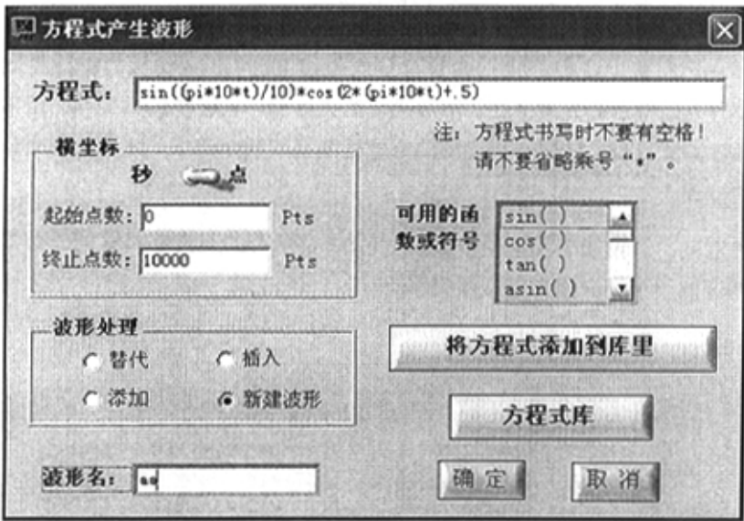
图 3-2 数学方程式生成波形的对话框
