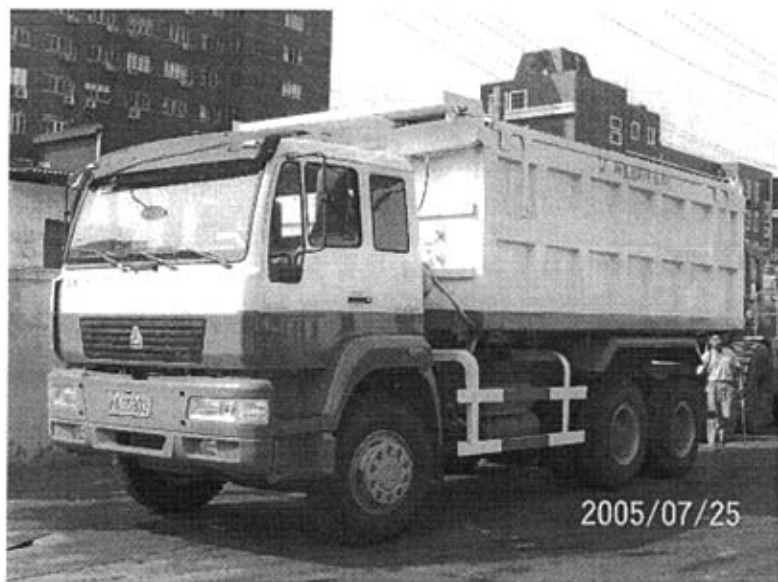
图 4-2 加盖自卸式垃圾运输车
